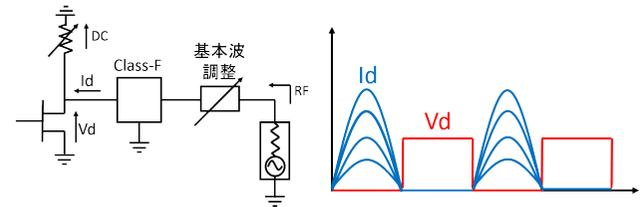
F級高調波終端条件を保ちつつ、基本波インピーダンス終端値を変化させ、電圧波形を変えずに電流波形を相似変化
